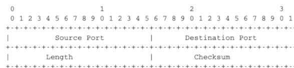
Fig. 3.19: UDP Header Format
