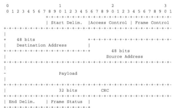
Fig. 2.80: 802.5 data frame format
